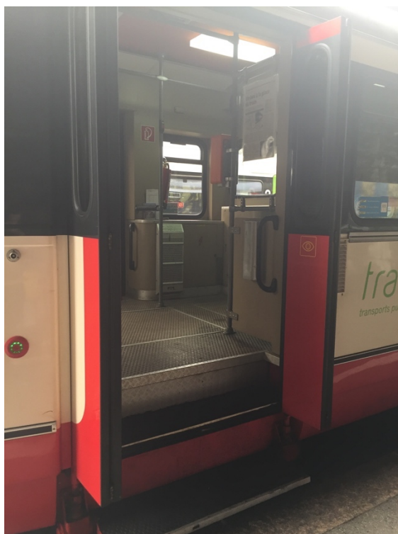
Le Régional en gare du Locle le 06 février 2021 | L'accès aux wagons est difficile pour les personnes à mobilité réduite, les personnes âgées et tous les transports à roues (poussettes, chariots à commissions, vélos, etc...) | Photo : Romain Bélisle
