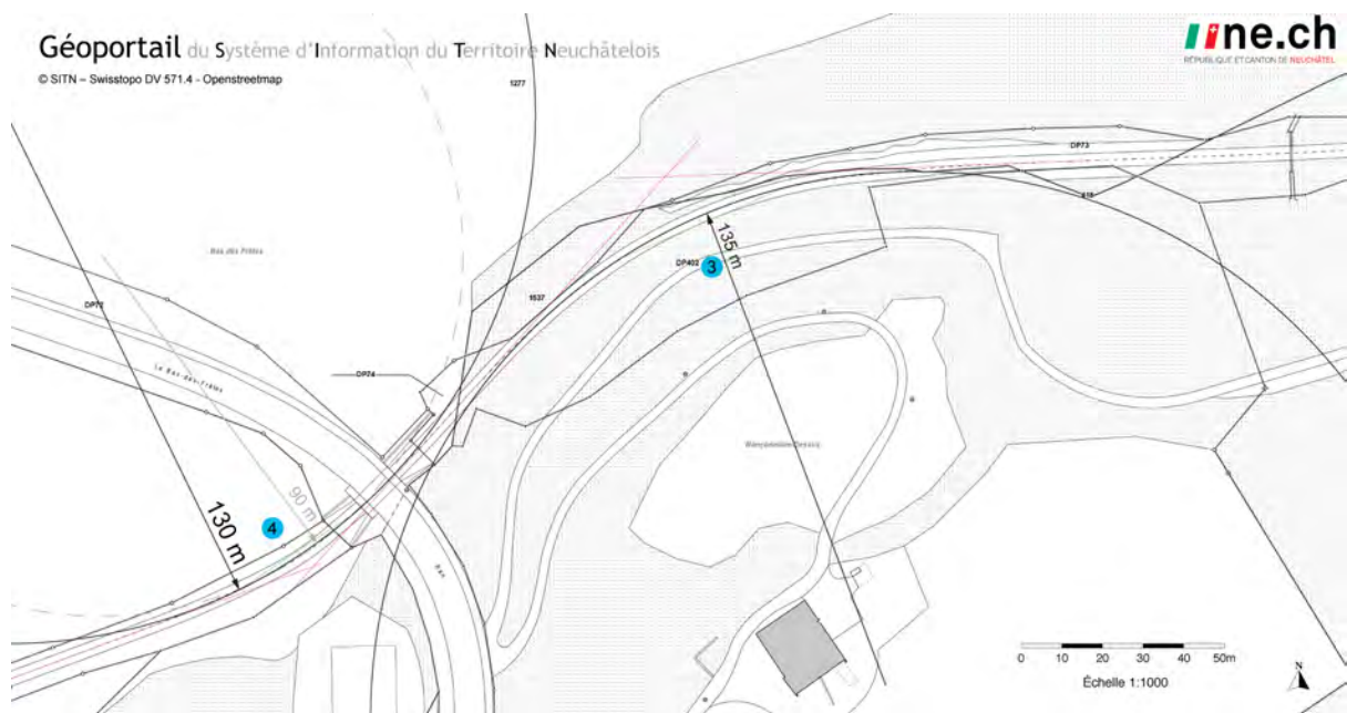
Fig. 61: Rayons de courbure n° 3 et 4 au pont routier de la RC 169
