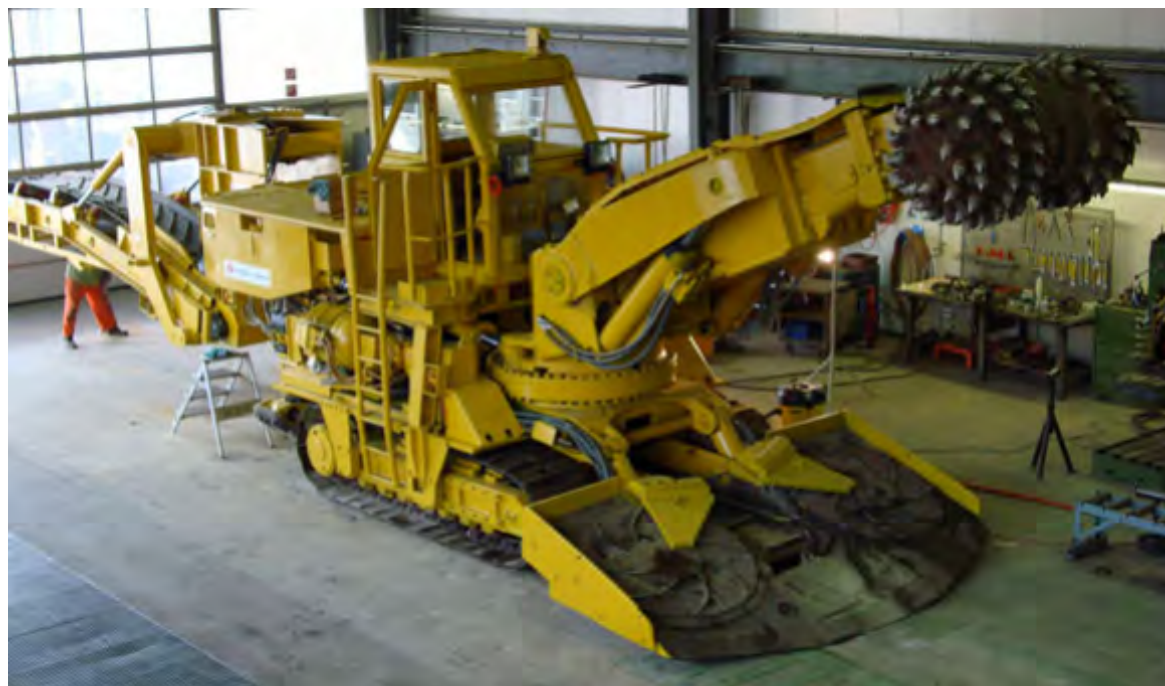
Fig. 12: Machine à attaque ponctuelle envisageable pour l'augmentation du profil 18
