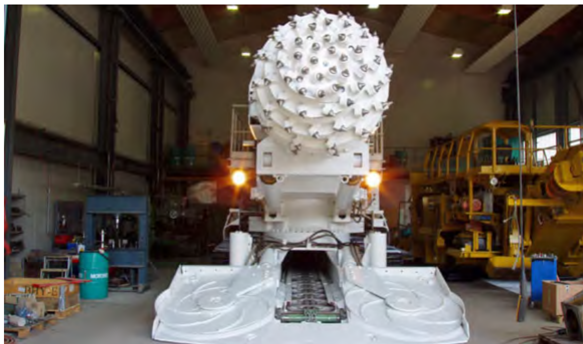
Fig. 13: Machine à attaque ponctuelle envisageable pour l'augmentation du profil 19
