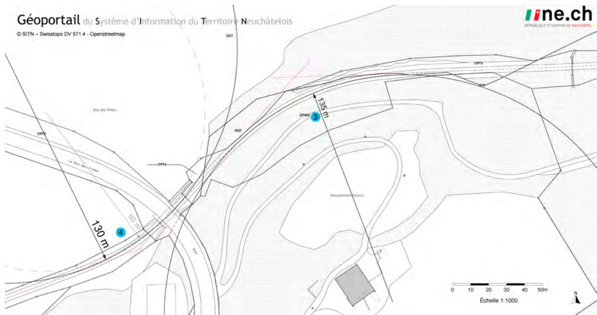
Fig. 5: Rayons de courbure 3 et 4 avec le pont routier de la RC169
